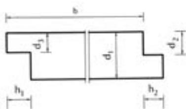
**Figura 27** Profilo battentato - Min. spessore **12 mm**
